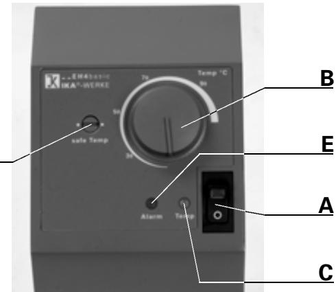
Le thermostat suspendu EH4 basic est mis en marche avec l'interrupteur à bascule (**A**). La lampe témoin intégrée est allumée et de couleur de verte. Pour ajuster la température du bain, sélectionnez la température voulue sur l'échelle du bouton rotatif „Temp“ (**B**).
