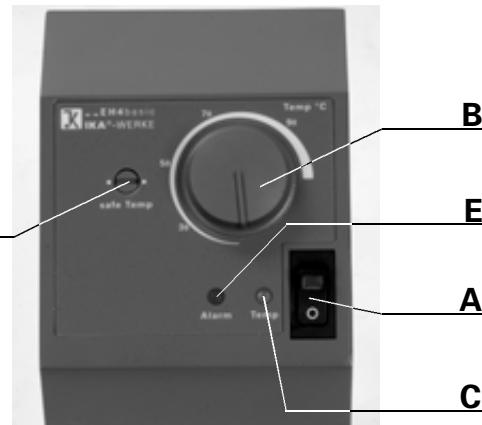
Der Einhängethermostat EH4 basic wird mit dem Wippschalter (**A**) eingeschaltet. Die eingebaute Signalleuchte leuchtet grün auf. Die gewünschte Badtemperatur wird am Drehknopf „Temp“ (**B**) mit der dazugehörigen Skala eingestellt. Die Aufheizphase wird durch die gelbe Signalleuchte (**C**) angezeigt, die beim Erreichen der Solltemperatur im Ein- und Ausschaltrhythmus der Heizung aufleuchtet. Die eingestellte Badtemperatur kann mit einem Kontrollthermometer nachgeprüft werden.
